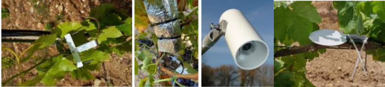
Figure 6: Dendromètre, capteur de flux de sève, caméra NIR (à Proche Infrarouge), capteur d'humectation
